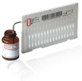
Test systemu TEMPO® , butelka z pożywką i połączona z nią karta odczytu
