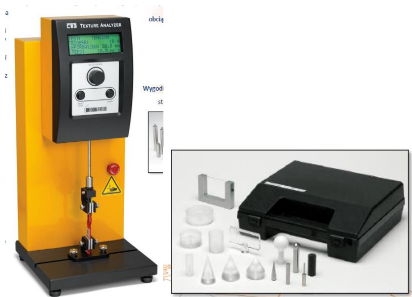
Teksturometr Brookfield CT3 (Brookfield Engineering Laboratories z Middleboro, USA) wraz z wymiennymi sondami prostymi i oprogramowaniem TexturePro CT
